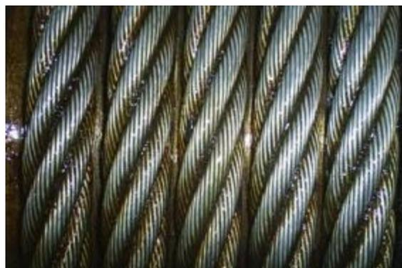
Con nuestro sistema de dos capas, el penetrante AIGI 862 limpia y lubrica internamente todos los filamentos del cable, mientras el encapsulante 773C sella la superficie dejando el penetrante dentro y los agentes de contaminación fuera.
