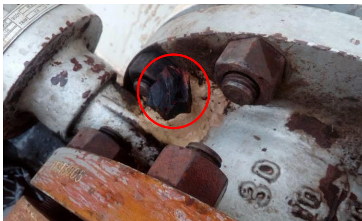
Foto No. 12 Calaján No. 1 Cortado Válvula 3415
