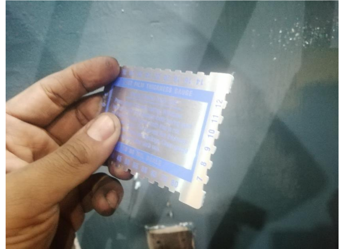
Segunda, Tercera y Cuarta Capa: 9 mil espesor mínimo c/u.
