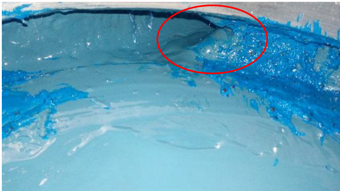
Corte de Agua deteriorado aún después de la reconstrucción de soldadura. En la imagen ya tiene aplicada primera capa ARCOR S20
