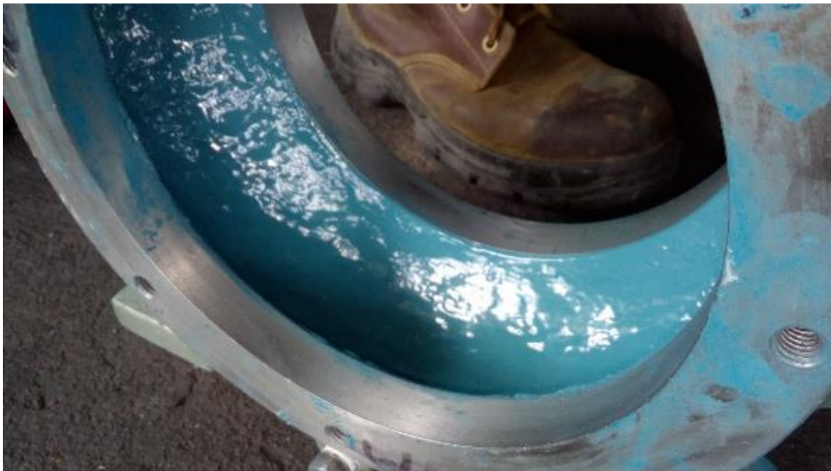
Aplicación Capa Final ARCOR S-20
