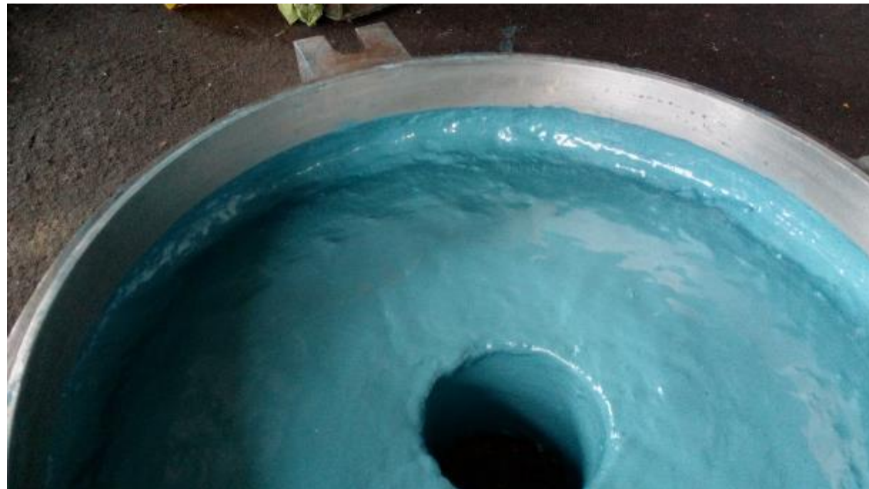
DESPUES. Mejora Perfil hidrodinámico al haber menor fricción al flujo
