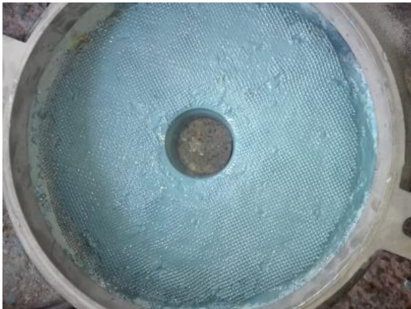
Voluta Bomba Inal reconstruida inicialmente con Soldadura
