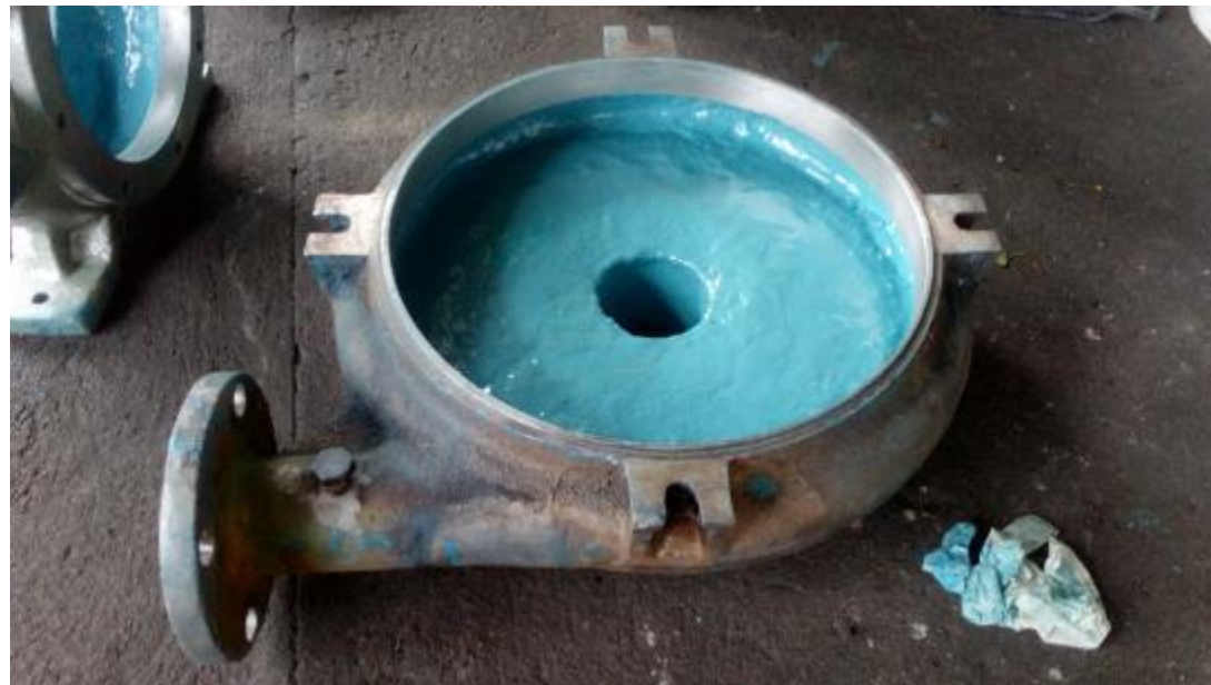
Voluta Bomba Inal Recubierta con ARCOR S-20 y 8508
