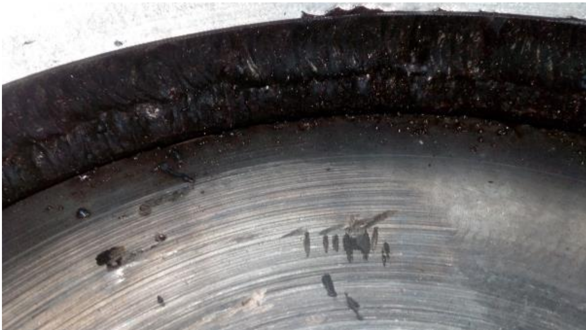
Antes. Rugosidad interna del proceso de soldadura
