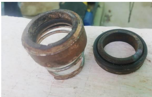
Sello Mecánico Deteriorado,
