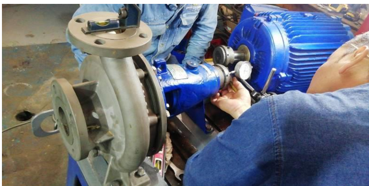
Nivelación Bomba, y alineación angular
