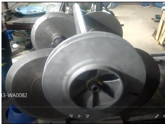
Impulsor en Prueba de Balanceo
