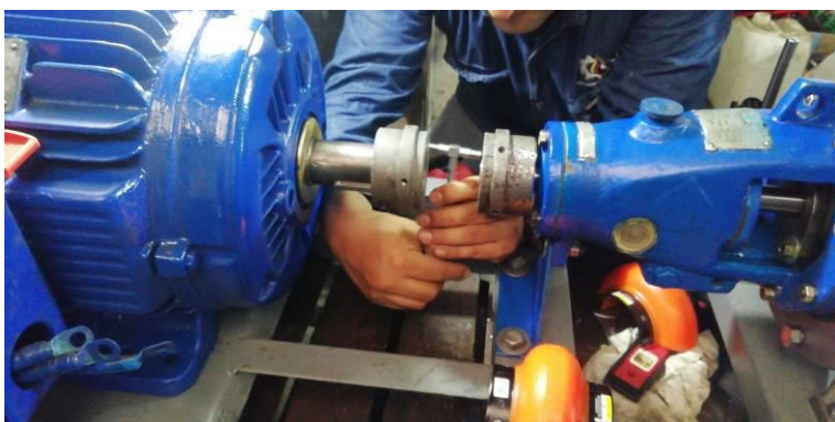
Nivelación Bomba, y alineación angular
