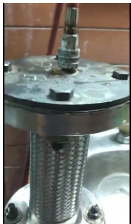
Pruebas estanqueidad Flexibles
