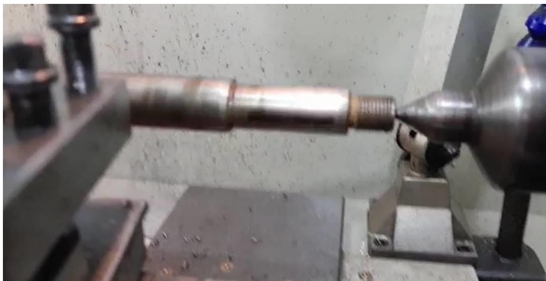
Prueba en Torno, Rectitud de eje Bomba
